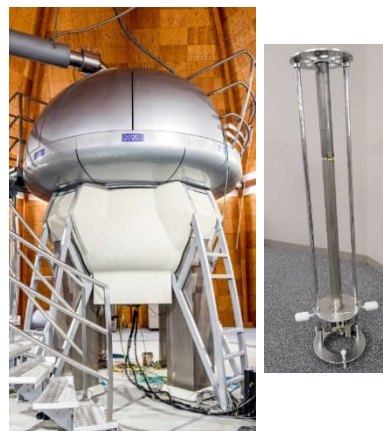
図 1 理化学研究所 固体 NMR 左：固体 900MHz NMR 右：3.2mm プローブ
